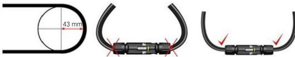
图12 电缆的最小弯曲半径
