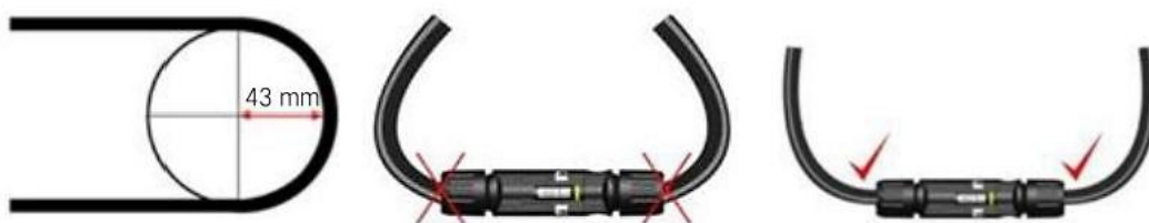
图12 电缆的最小弯曲半径
